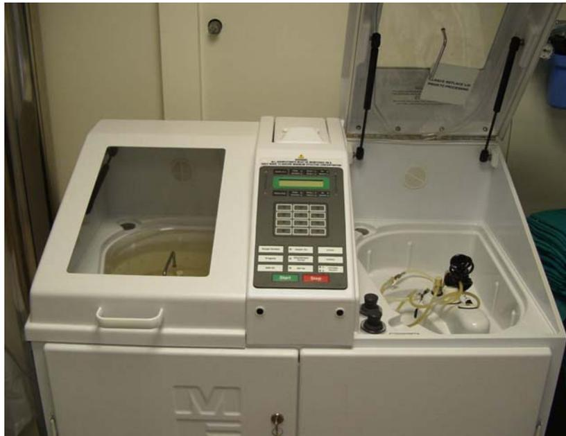
**Medivators®: Aparato de desinfección automática para endoscopios flexibles. Dispone de dos cubetas independientes de desinfección; permite la utilización de distintos desinfectantes y tiempos de exposición para conseguir el nivel de desinfección necesario.**
