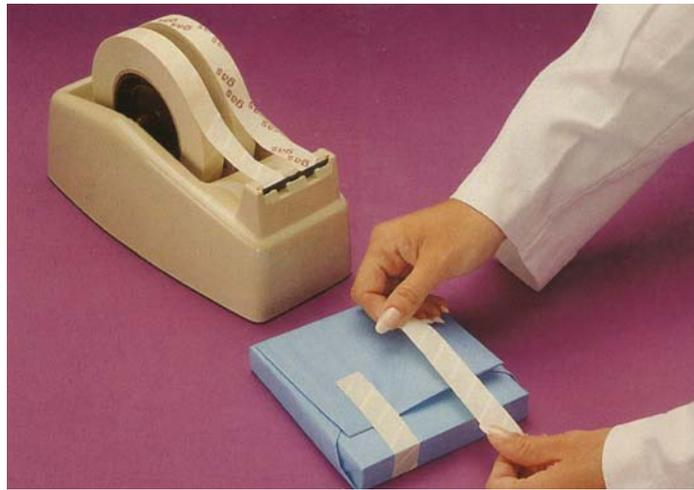
**Indicadores químicos externos en las cintas adhesivas que fijan los envoltorios de los paquetes. Su viraje permite saber que el paquete se ha sometido a un proceso de esterilización (no asegura que el proceso haya sido correcto)**
