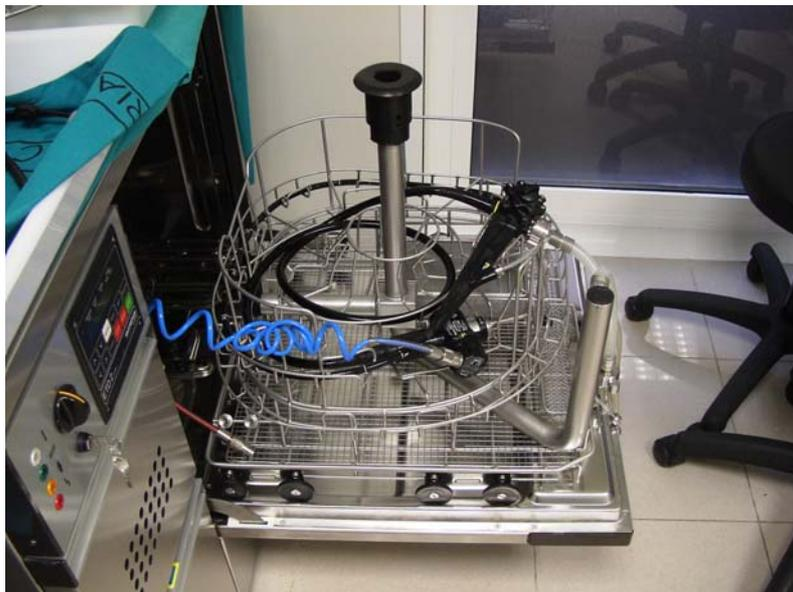
**Olympus® ETD2+: Forma de colocación de un endoscopio flexible en una lavadora automática Olympus® ETD2+**
