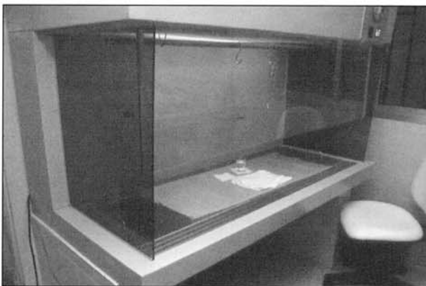
Fig. 2. Cabina de flujo laminar vertical.
