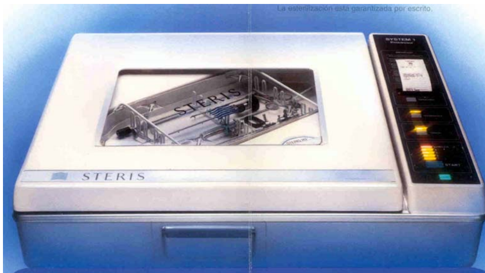
Máquina automática de desinfección Steris® que desinfecta a temperatura elevada (56°C) utilizando ácido peracético.
