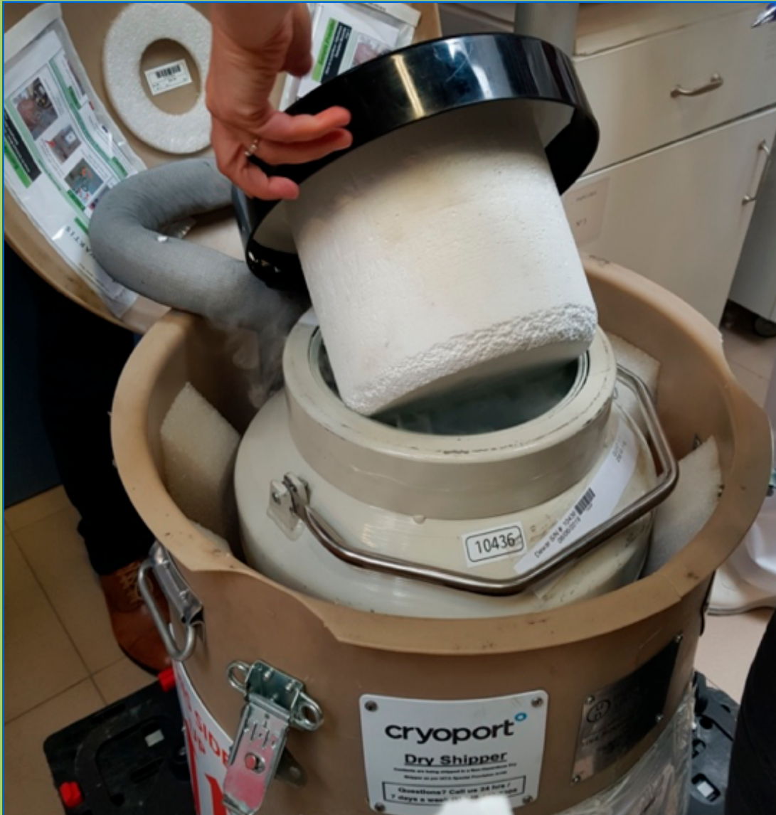
Figura 7. Recipiente Dewar abierto en la recepción de un medicamento CAR-T.
