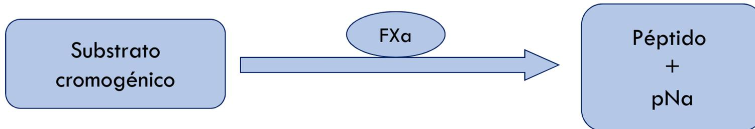
Hidrólisis de substrato cromogénico, liberación de color medido mediante espectrofotómetro a 405 nm
